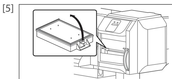
フラッシングボックス用吸収材のツメ部を持ち上げてフックを解除し、
