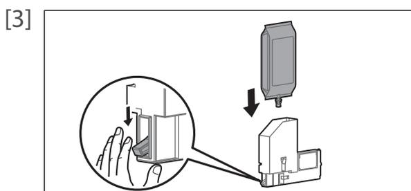
大容量パックアダプターのロックレバーを下げながら、インクパックを挿入します。
