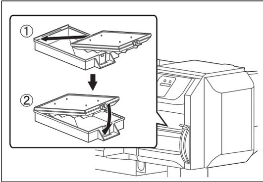
新しいフラッシングボックス用吸収材を取り付けます。
