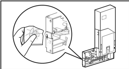
プリンター付属のペーパータオルで、大容量パックアダプターの差し込み口に付着しているインクを拭き取ります。
