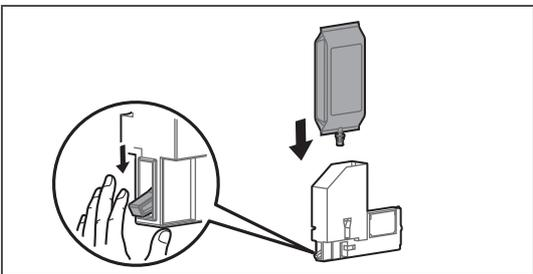
大容量パックアダプターのロックレバーを下げながら、インクパックを挿入します。
