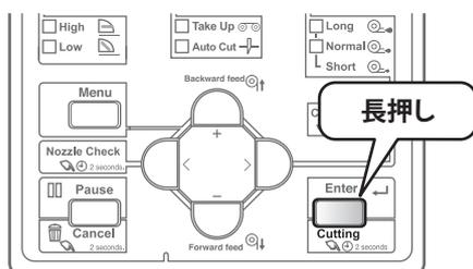
操作パネルの [Cutting] キーを 2 秒以上押しします。
