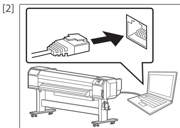
ギガビットイーサネットケーブルを、コンピューターに接続します。
