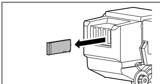
インクカートリッジ (または、大容量インクパックアダプター) を、インクカートリッジスロットから取り外します。
