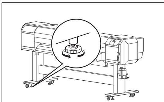
専用スタンドのアジャスター（4箇所）を、左図の方向に回転させて緩めます。
