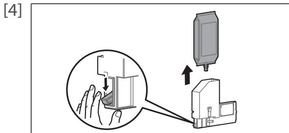
大容量パックアダプターのロックレバーを下げながら、空のインクパックを取り外します。
