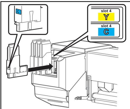
大容量パックアダプターを元のカートリッジスロットに取り付けます。
